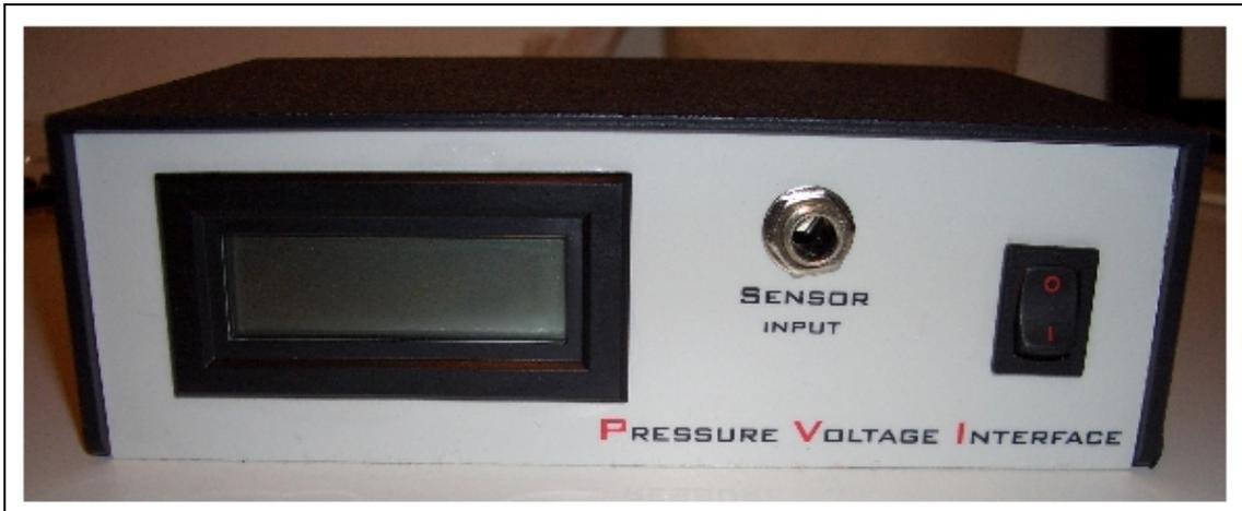
Abb. 3.5.: Frontseite des FSR-Prototypen mit Sensor-Buchse und LCD-Spannungsanzeige
