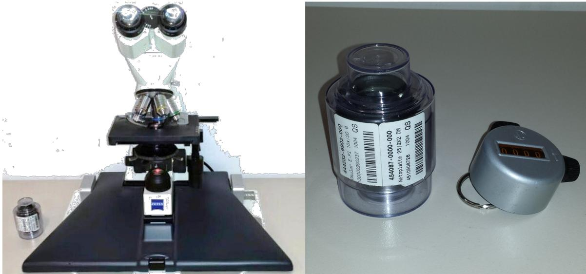
**Abbildung 11: Zeiss Mikroskop (links) und das Zählkular (rechts).** Dieses Mikroskop wurde für die Zellzählung herangezogen. Rechts sieht man das Okular mit integriertem Zählgitter 25/ 2x2 DM Zeiss (Durchmesser 25 mm) zusammen mit dem Handzähler.
