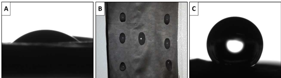
Abbildung 23: Bilder der Kontaktwinkelmessung auf Scaffold 8 und 12P. (A) zeigt den Wassertropfen von der Seite auf Scaffold 8. (B) Bei Betrachtung der Wassertropfen auf Scaffold 8 von oben erkennt man die Ausrichtung der Tropfenform. (C) Ein Wassertropfen auf dem porösen Scaffold mit einer annähernd runden Form.
