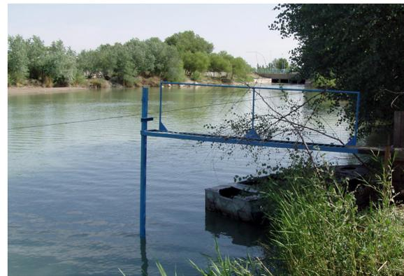
**Abbildung 7-9:** Sowjetische Infrastruktur zur Installation von Schwimmpegeln (Turangi Saka, links) und zur Kompletzierung des Messnetzes aus dem Projektbudget im Gelände errichtete Messstellen (Urgench Arna, rechts); beide Stationen sind auch offizielle Messpunkte der BWO Amu Darya.
