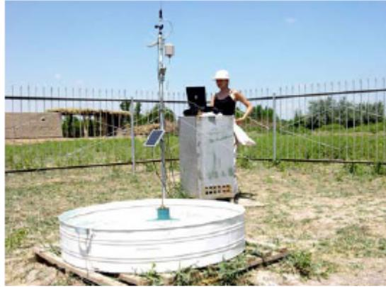
**Abbildung 6-8:** Die meteorologische Station in Khiva, im Vordergrund eine *class-A-pan* (Foto: FORKUTSA, 2006).
