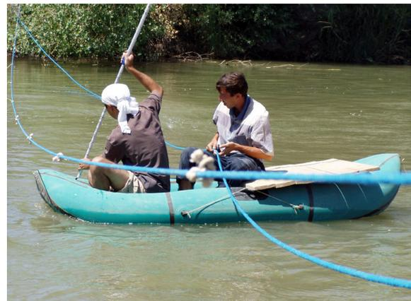
**Abbildung 7-12:** Vorbereitung (links) und Durchführung (rechts) einer Abflussmessung.
