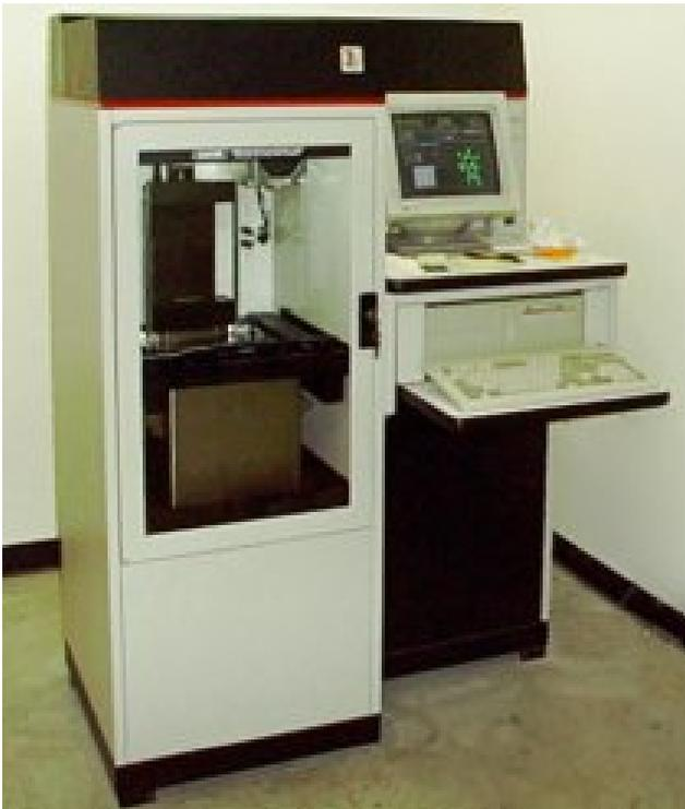
Abbildung 9: Stereolithographie-Einheit SLA-250 (3D-Systems, Darmstadt)
