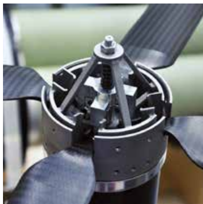
Vier Flügel lassen das Objekt um seine Achse rotieren: Ansichten eines SpaceSeed. (Bilder: Christoph Fröhlich)
