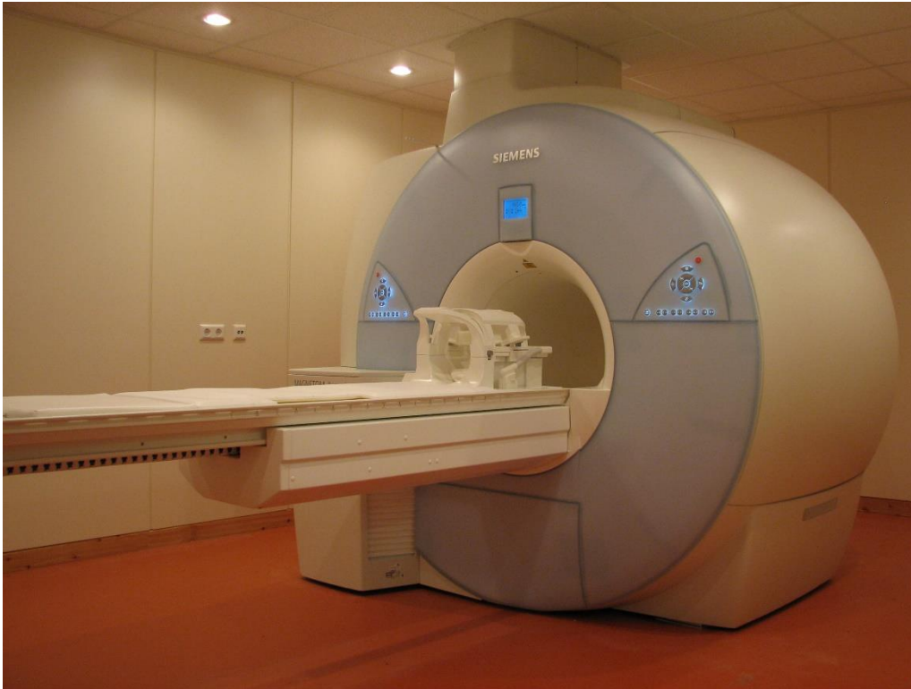
Abbildung 2.7: Kernspintomograph Avanto von Siemens mit 1,5 Tesla.
