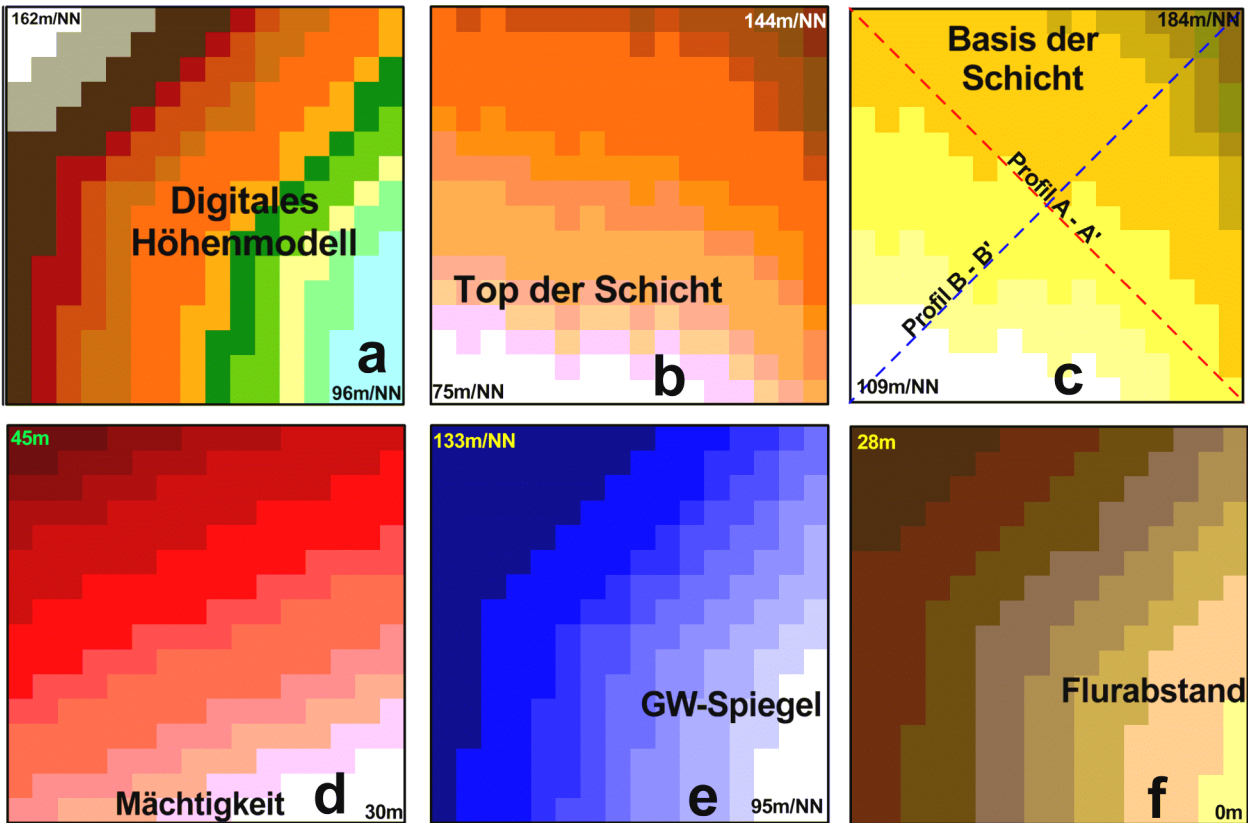
Abbildung 8-2: Basisgrids (Raster) für die Erstellung einer Abfrage, in der die für den Einsatz von grundwassergekoppelten Wärmepumpen geeigneten Gebiete auf einer Beispielfläche von 16x16 Rasterzellen bestimmt werden sollen. Die Kriterien für die Abfrage sind: Maximale Bohrtiefe 20m, minimale Grundwassermächtigkeit im Aquifer 5m. Digitales Höhenmodell [a], Digitales Strukturmodell (hier mit den Komponenten Top [b], Basis [c] und Mächtigkeit [d] der Schicht) und Grundwasserspiegelplan [e] stellen die Grundlage der Berechnungen dar. Mit diesen Informationen kann die Lage und Form einer Schicht im Raum beschrieben werden. Die Profile A – A' und B – B' zeigt Abbildung 8-3.
