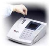
Schritt 1: Einsetzen der Kartusche
