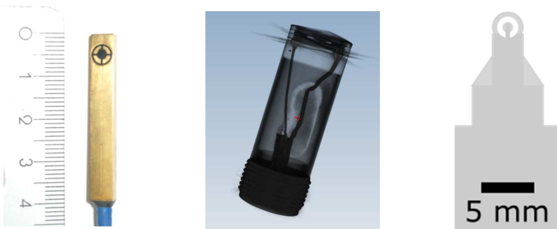
Abbildung 2 Es existieren zahlreiche unterschiedliche Detektoren mit individuellen Eigenschaften. Beispielhaft gezeigt ist hier das Foto einer EDGE-Diode (links), Rekonstruktion einer hochauflösenden computertomographischen Aufnahme der abgeschirmten Diode PTW 60008 (Mitte) und die schematische Zeichnung einer Mikro-Ionisationskammer iba CC003 (rechts).
