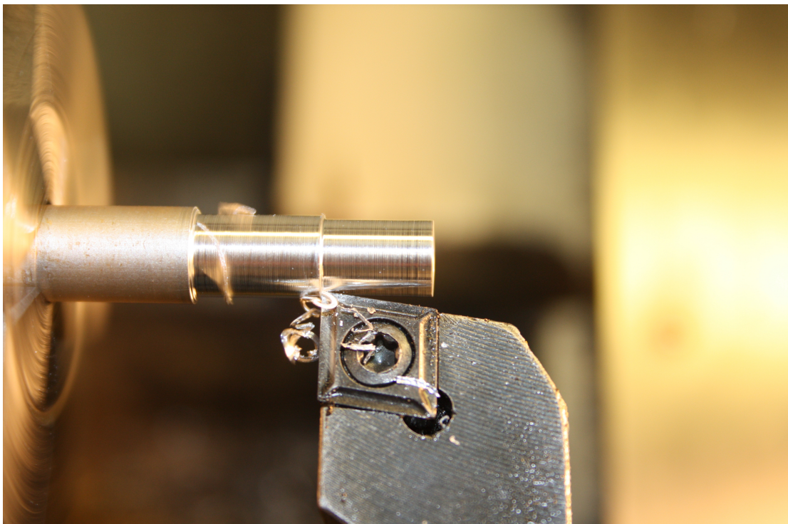
Abbildung 6: Herstellung der Messspitzen auf einer Drehmaschine; Quelle: eigenes Foto
