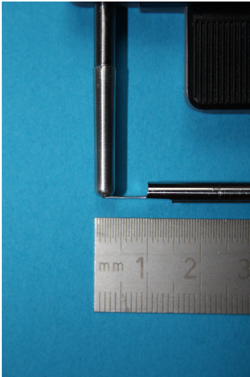
Abbildung 7: Detailaufnahme der modifizierten Messspitzen; Quelle: eigenes Foto
