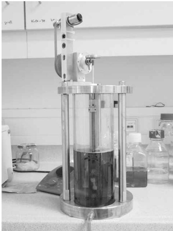
**Abb. 1 B:** Kreuzbandkonstrukt eingespannt in den Bioreaktor zur zyklischen Dehnung
