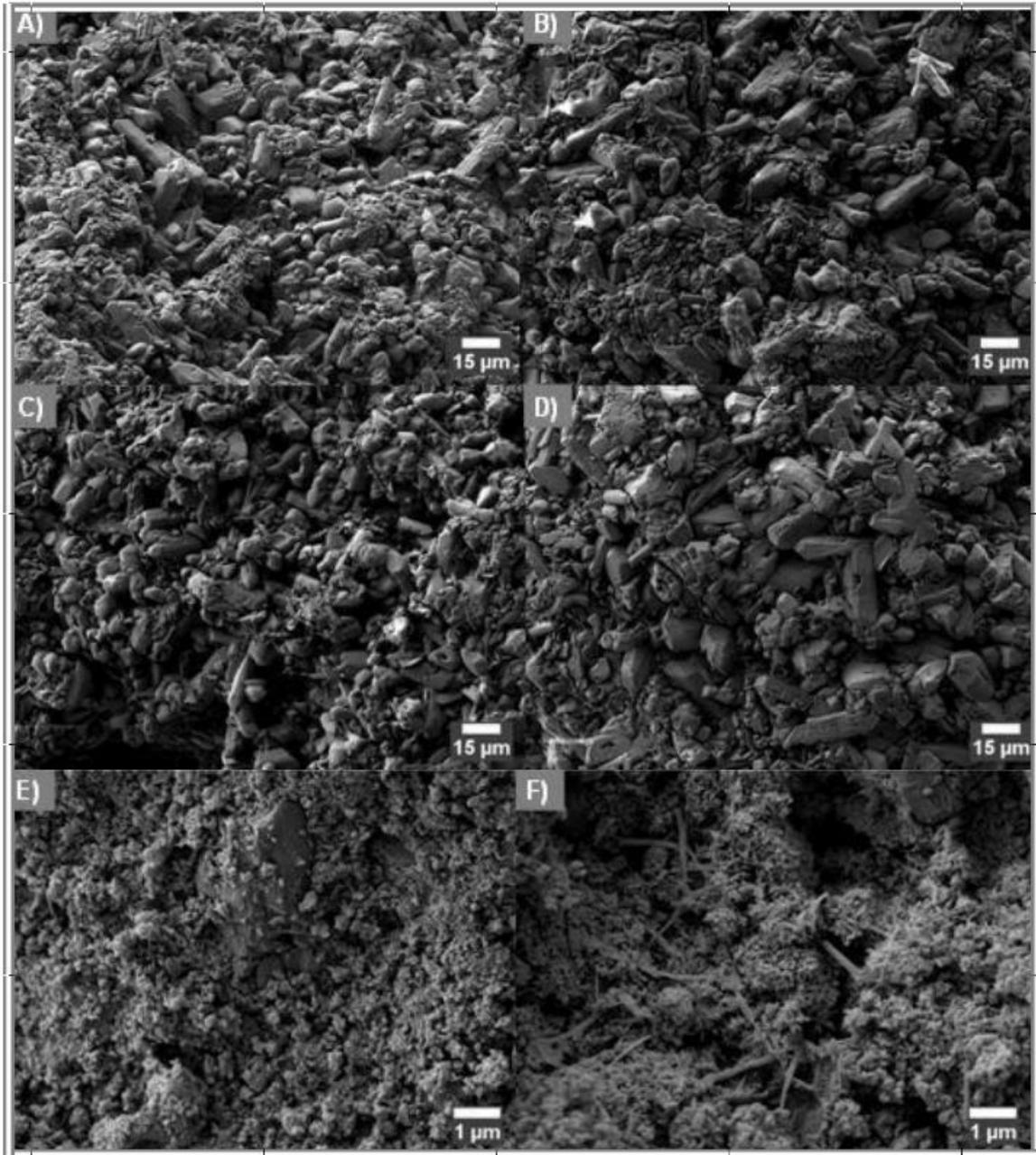
**Abbildung 16:** REM-Aufnahmen der Granulate vor und nach der  $\gamma$ -Sterilisation ; wobei **A),C),E)** die Granulate vor der Sterilisation und **B), D), F)** nach der Sterilisation zeigen; **A),B)** Granulate aus  $\text{Ca}_{0,25}\text{Mg}_{2,75}(\text{PO}_4)_2$  bei 1000-facher Vergrößerung ; **C), D)** Granulate aus  $\text{Ca}_{0,75}\text{Mg}_{2,25}(\text{PO}_4)_2$  bei 1000-facher Vergrößerung ; **E),F)** Referenzgranulat bei 10 000-facher Vergrößerung.
