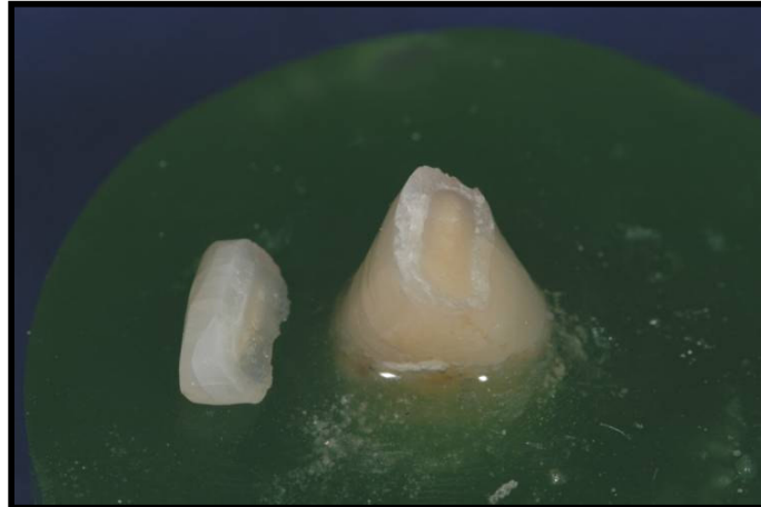
Abbildung 8: Zahn und Fragment nach erstem Bruchversuch
