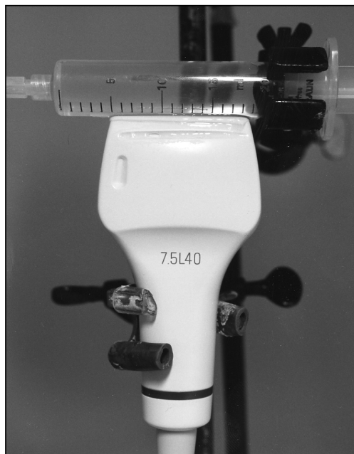
Abb. 2.3: Ausschnitt der Befestigung Spritze und Schallkopf; Spritze mit 0.9%iger NaCl-Lösung gefüllt dargestellt
