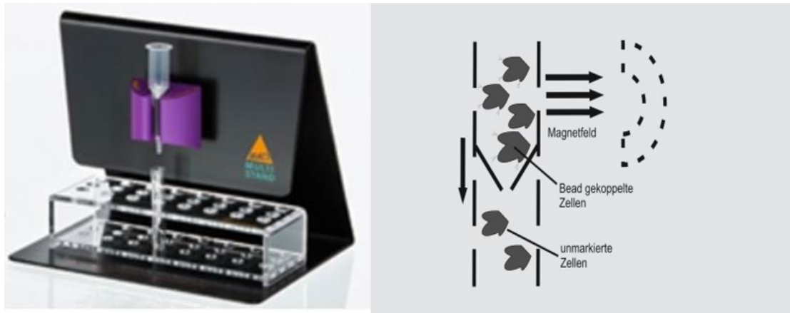
Abb. 5: Magnetische Zellseparation, Apparatur und Funktionsprinzip, (modifiziert nach [5])
