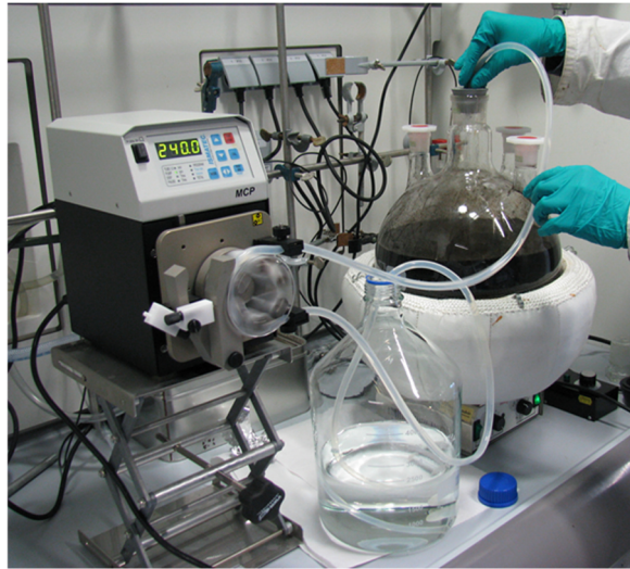
Abbildung 40: Versuchsaufbau zur Herstellung von ca. 80 g magnetischer Trägerpartikel als ersten Hochskalierungsschritt. Die Produktmenge konnte bei einer Verdreifung des Zeitaufwandes vervierzigfacht werden.
