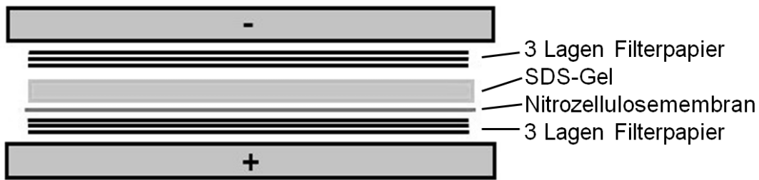
Abbildung 8: Aufbau des Western Blots . Je drei Lagen Filterpapier liegen zwischen Anode (+) und Kathode (-) und dem SDS-Gel, das luftblasenfrei auf einer Nitrozellulosemembran liegt.
