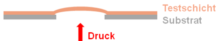
Abbildung 2.6: Schematische Darstellung eines Blistertests.
