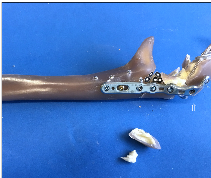
Abb. 41: Beispiel für Zerstörungsbild eines Knochens mit Olekanon Zwillingplatten nach LTF-Testung.
