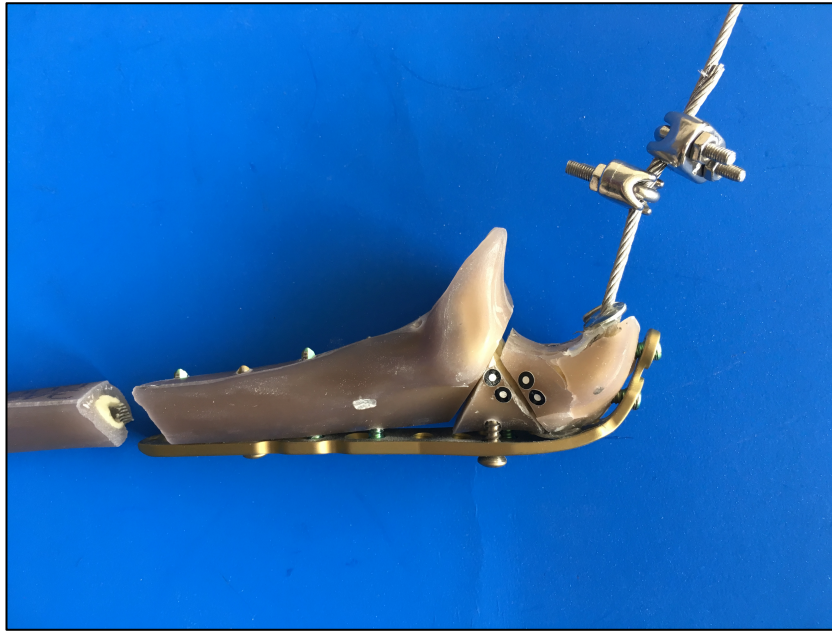
Abb. 42: Beispiel für Zerstörungsbild eines Knochens mit LCP- Olecranonplatte nach LTF-Testung.
