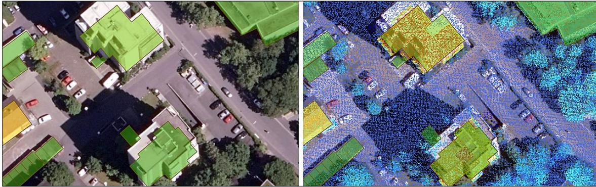
Abbildung 25: Der Effekt der Verkippung bei Aufnahmen aus dem Off-Nadir.
