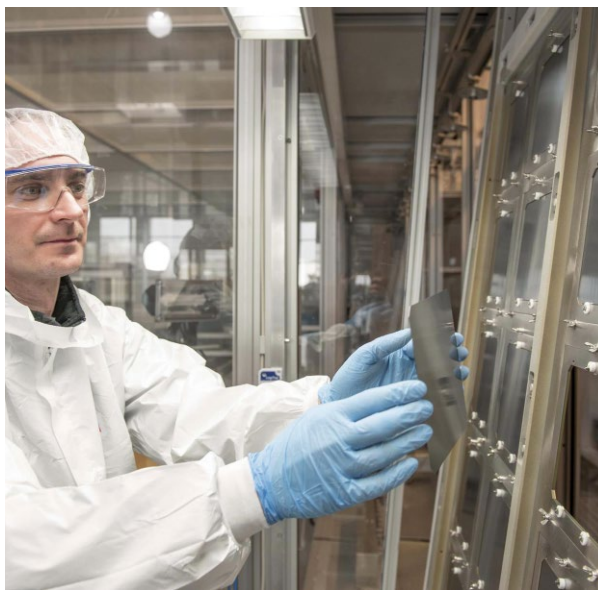
Abb. 1 Pilotlinie für die Produktion von Silizium-Perowskit-Tandemsolarzellen bei der Oxford PV GmbH in Brandenburg (© 2019 Oxford PV).
