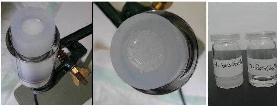
**Abb. 3.32:** (Links) Agaroseblock gefüllt mit einer *Microbubble*-Suspension in PBS-Puffer vor der Beschallung und (Mitte) nach der Beschallung. Die Ultraschallquelle ist von unten an den Agaroseblock gekoppelt und daher nicht sichtbar (rechts) In ein Glasgefäß überführte *Microbubble*-Suspension vor (v.) und nach (n.) dem Beschallen.
