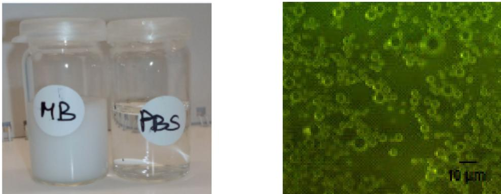
**Abb. 3.28:** (Links) Vergleich einer wässrigen *Microbubble*-Suspension (MB) mit reinem PBS-Puffer (rechts) Fluoreszenzmikroskopische Aufnahme von *Microbubbles*, die mit 1,1'-Dioctadecyl-3,3,3',3'-tetramethylindocarbocyanin-Perchlorat angefärbt wurden.
