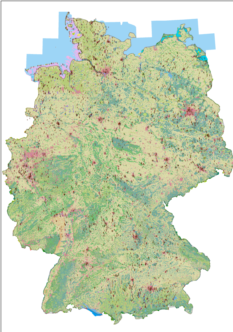
Abbildung 3.6: Im Rahmen dieser Arbeit wurden Trainingsgebiete für die CLC Klassen aus 12 Landsat ETM+ Szenen generiert, um die spektrale und temporale Variabilität der Klassen für den Stützvektorklassifikator zu beschreiben.
