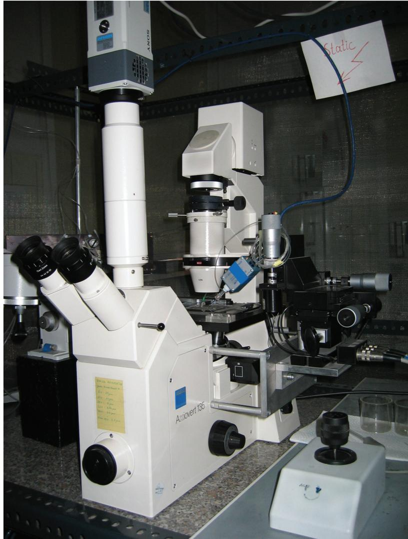
**Abbildung 11:** Patch-clamp Versuchsstand
