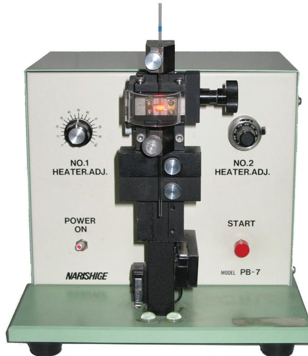
**Abbildung 10:** Abbildung des Pipetten-Ziehgerätes
