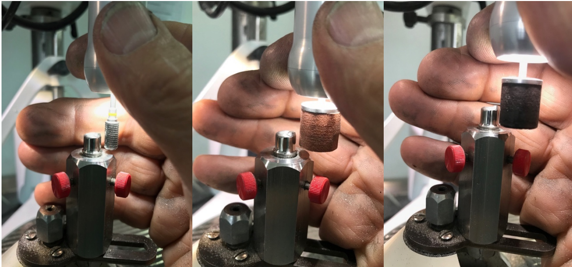
Abb. 15 0°-Parallelfräsen der Primärkronen (Hartmetallfräse und Konator-Flex-System: 240 \mu\text{m} - 600 \mu\text{m} ) (eigene Darstellung)
