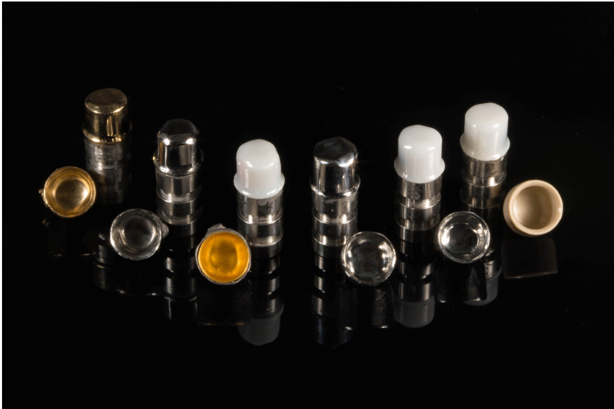
Abb. 6 Doppelkronen in den getesteten Materialkombinationen (Gold- und Cobalt-Basis-Legierung, Zirkoniumdioxidkeramik, PEEK) und Herstellungsmethoden (eigene Darstellung)
