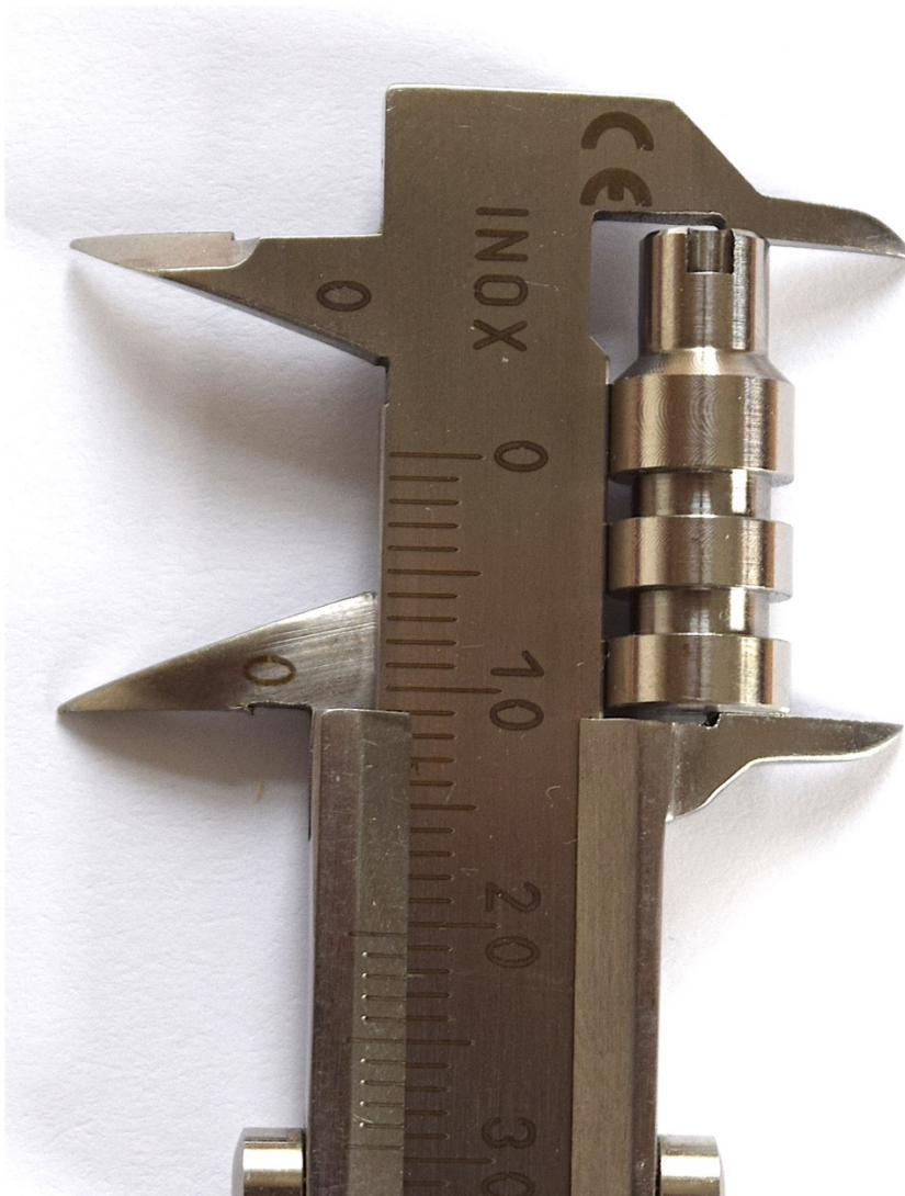
Abb. 11 CNC-gefertigter Prämolarenstumpf mit Rotationsschutz (eigene Darstellung)
