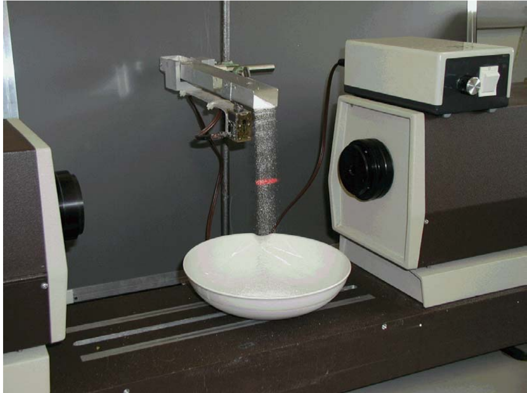
Abbildung 5-62 Rinnenbestimmung mit Malvern Particle Sizer® 2600
