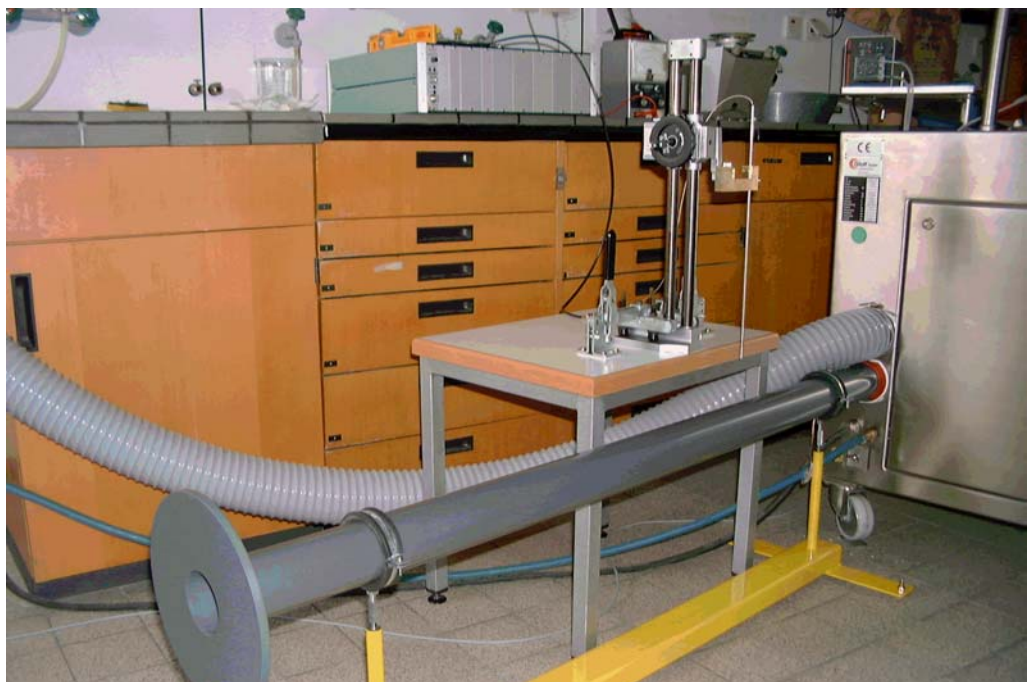
Abbildung 5-39 Einlaufstrecke vor dem Ansaugstutzen des GPCG
