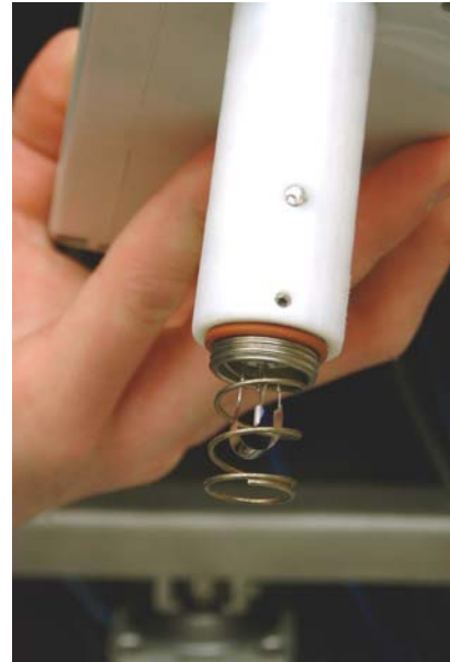
Abbildung 5-9 Hygromess Transmitter Typ 41 (Schutzkappe abgenommen)
