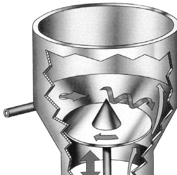
Abbildung 2-9 Rotorverfahren mit Side-spray-Einrichtung
