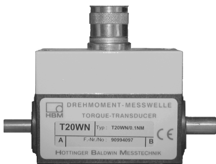
Abb. 5.9 Drehmomentmesswelle T 20 WN (HBM)
