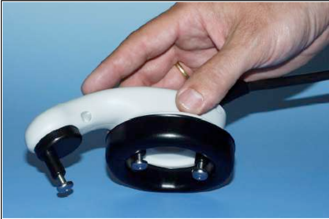
Abb. 2: BERAphon® mit integriertem Vorverstärker und Edelstahl Elektroden
