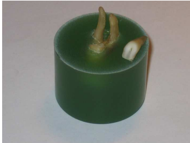
Abb. 10: frakturierte palatinale Wurzel nach erstem Bruchversuch
