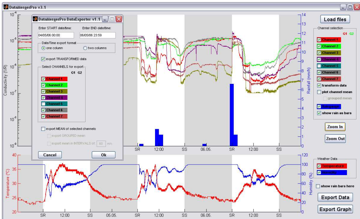
Abbildung 2.5.: Benutzeroberfläche der Software DataMergerPro die zur Vereinigung, Visualisierung und Verarbeitung der Peristomleitwert- und Klimaloggerdaten verwendet wurde.
