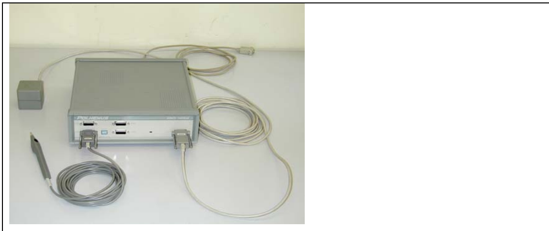
Abbildung 3-10: Elektromagnetisches Ortserfassungssystem Fastrak ® (Fa. Polhemus, Vermont, USA). Links oben ist der Signalgeber, darunter der handgeführte Detektionsstift zu sehen
