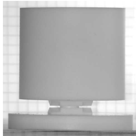
Abbildung 4.3: Aufbau zum Auflastsintern in der TOM.
