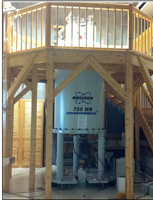
**Abb. 4: Bruker Avance 750 WB Magnetresonanztomograph**
