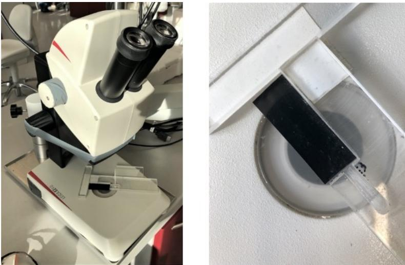
Abbildung 6: Mikroskop (links) & Führungsschiene (rechts) zum Scannen
