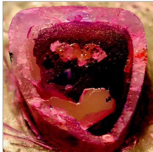
Abb. 3: Bruchfläche vor und nach der Färbung, farbige Überlagerungsmarken links und rechts im Schmelzbereich
