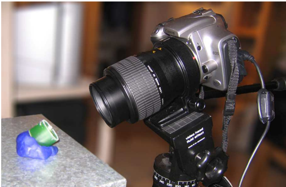
Abb. 4: Fotografieren der Bruchflächen mit Digitalkamera, Zahn mit Einbettkunststoff (grün), Knetmasse (blau)
