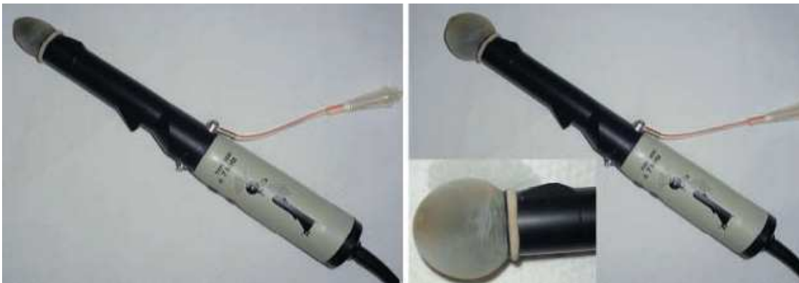
Abbildung 1. TRUS-Schallkopf; diese Modelle verfügen über einen Arbeitskanal für das Vorschieben einer Biopsienadel.
