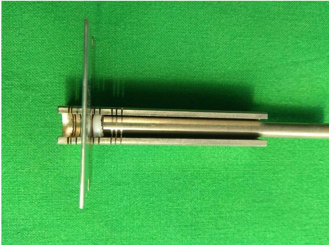
*Abb. 1: Schneidevorrichtung; einliegender Knorpelzylinder und eingebrachte Rasierklinge als Anlagefläche*
