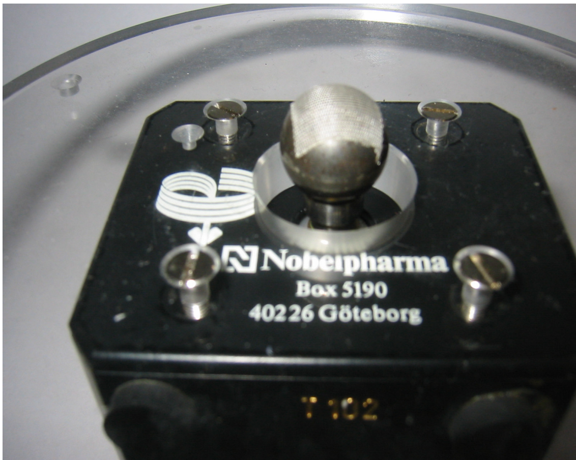
Abb. 7.2-6: Zur Dämpfung mit Leukosilk beklebte Metallkugel des (Haupt)Versuches 3, die auf dem Metallzylinder des Tu-1000 ruht.
