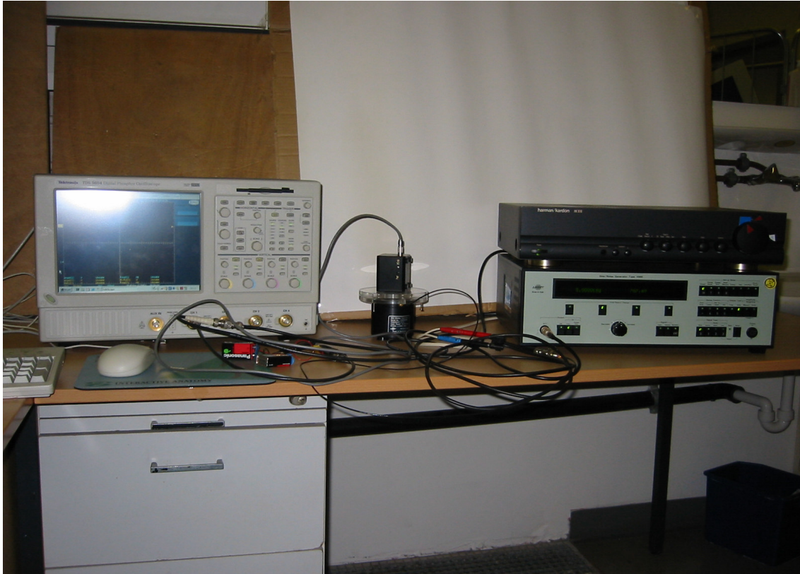
Abb. 8.1-2: Versuchsaufbau der Schwingungsmessung (vgl. Abb. 8.1-1)
