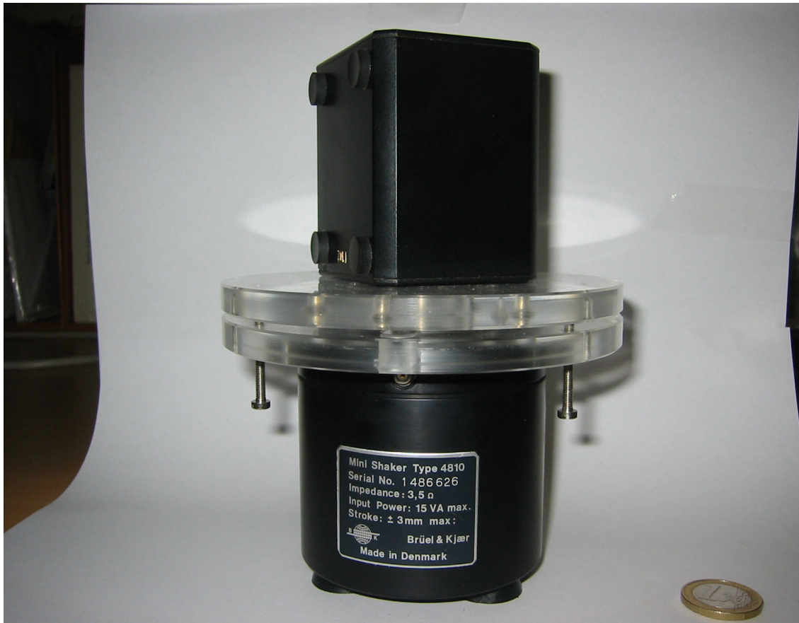
Abb. 8.1-5: Shaker (unten) mit aufgesetztem Tu-1000
