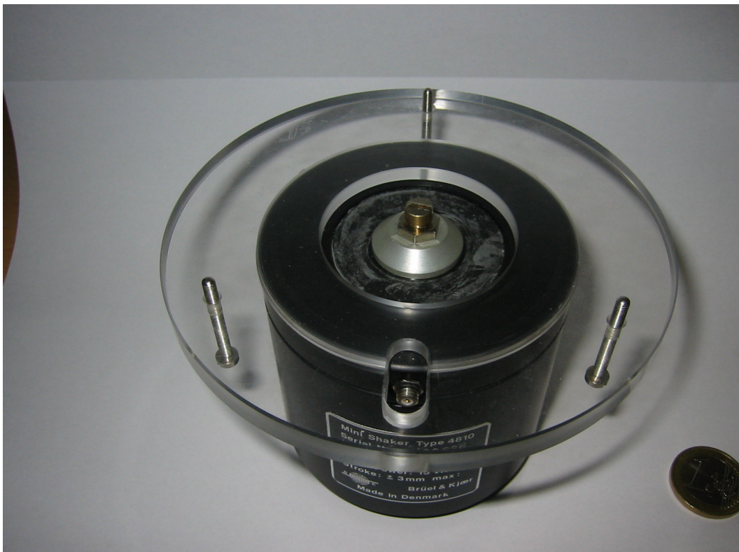
Abb. 8.1-3: Shaker mit aufgeschraubter Plexiglasplatte
