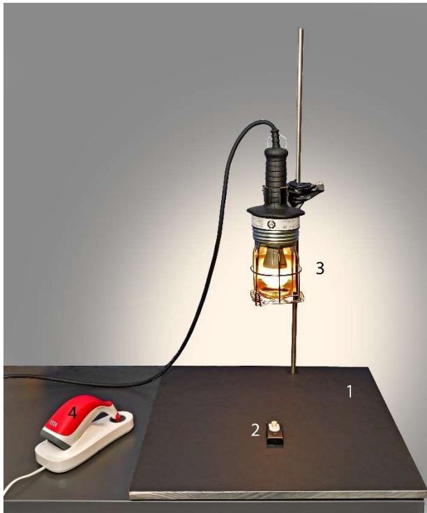
Abbildung 14: Messvorrichtung 1) Aluminiumplatte 2) Einbettform 3) Lichtquelle 4) Spektrophotometer (VITA Easyshade®V, Fa. Vita Zahnfabrik)
