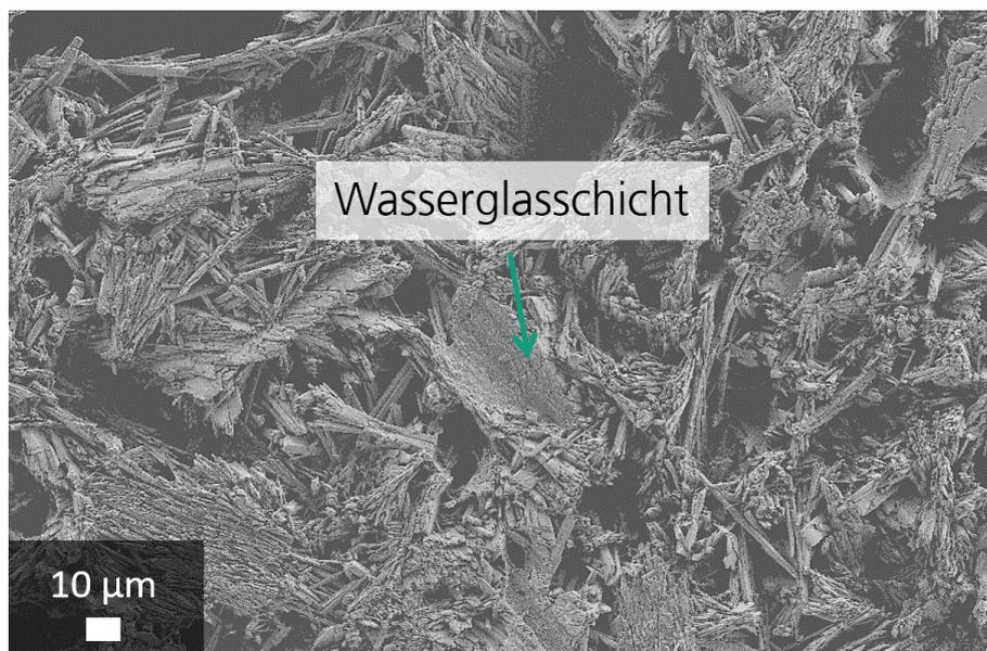
**Abbildung 38:** REM-Aufnahme einer REA-Gips-Probe mit 0,5 wt% Wasserglas.
