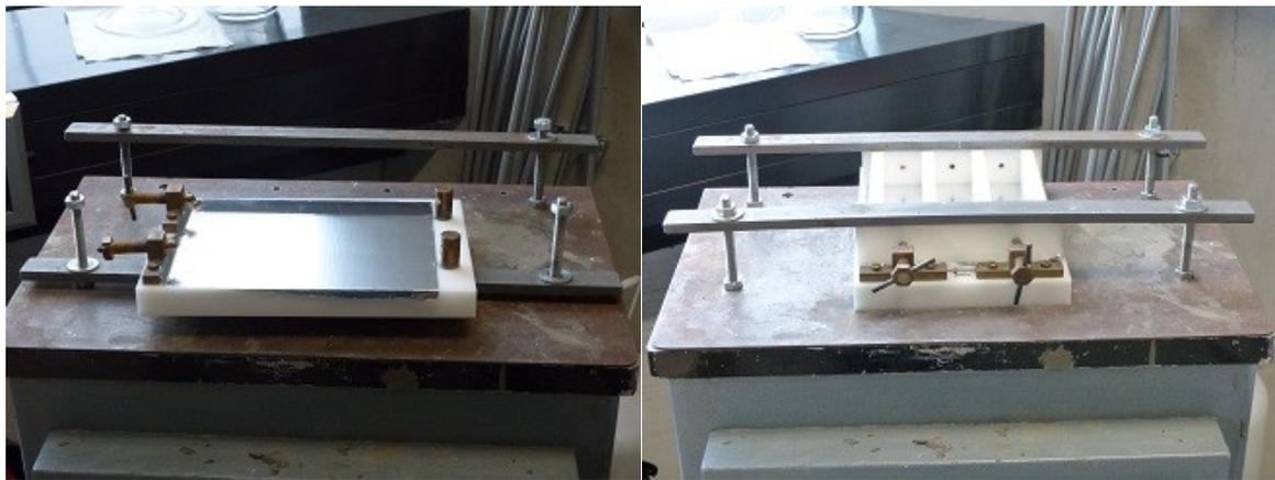
**Abbildung 44:** Vorbereitete Teflonform auf Rüttelplatte.
