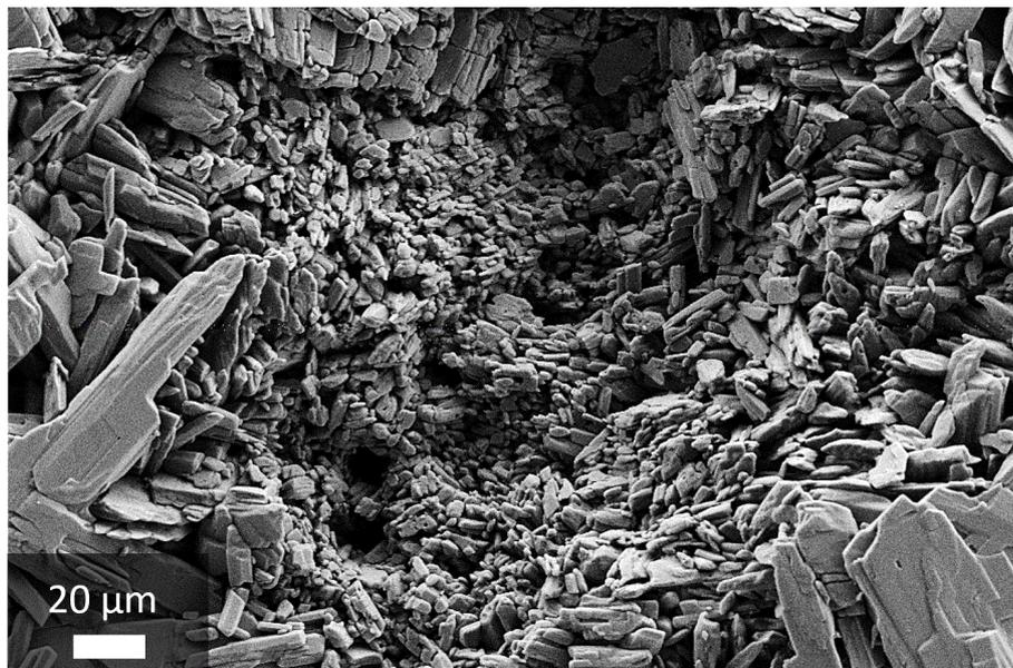
**Abbildung 11:** REM-Aufnahme vom Bereich höchster Zugbelastung einer gekrochenen Gipsprobe.
