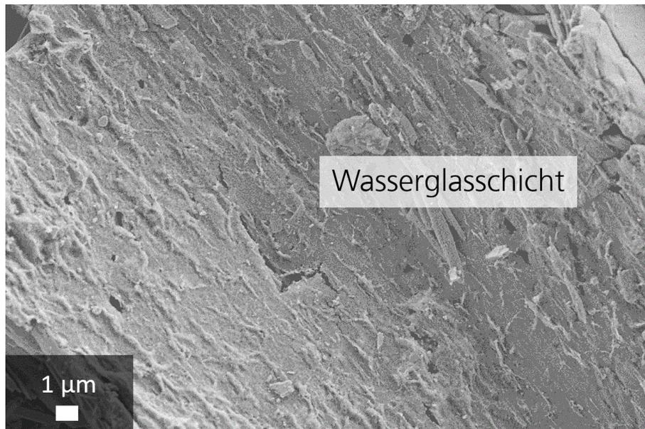
**Abbildung 39:** REM-Aufnahme einer REA-Gips-Probe mit 0,5 wt% Wasserglas.
