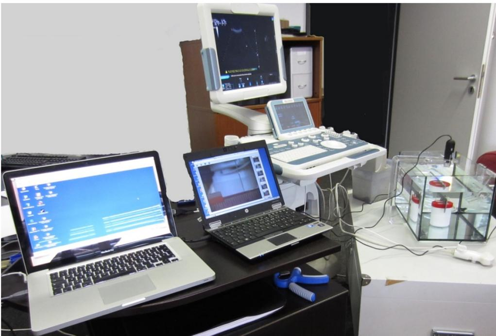
**Abb. 11** Darstellung des Versuchsaufbaus mit Wasserbecken, Ultraschallgerät und Laptops
