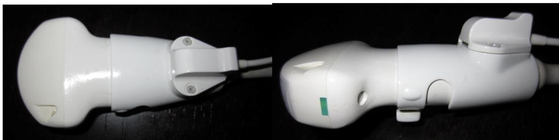
**Abb. 4 Ultraschallsonde mit Empfänger**
