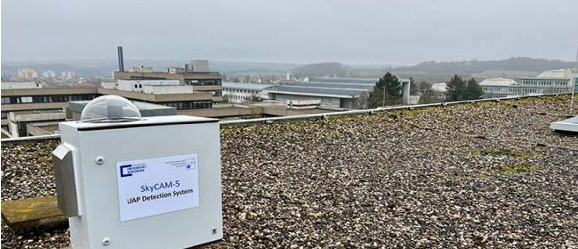
Etwa 70 Zentimeter hoch ist die Box, die das Kamerasystem SkyCAM-5 enthält. (Bild: Hakan Kayal / Universität Würzburg)
