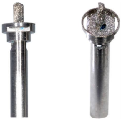
Abbildung 7 - Pilotschleifer des Würzburger Systems: mit diesem Werkzeug werden das zylindrische Basisloch und die umlaufende Nut geschaffen (Quelle: Dr. Julian Boldt/ Universität Würzburg)
