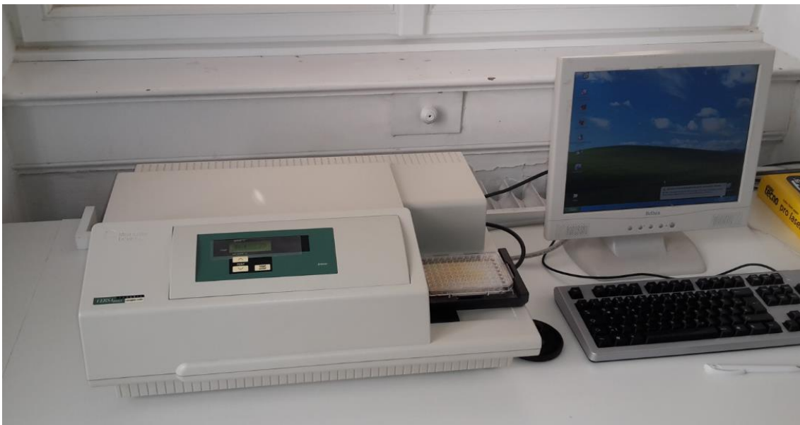
Abb. 1: Versuchsaufbau VersaMax®, Computer mit Softmax Pro Software und VersaMax ELISA Microplate Reader.
