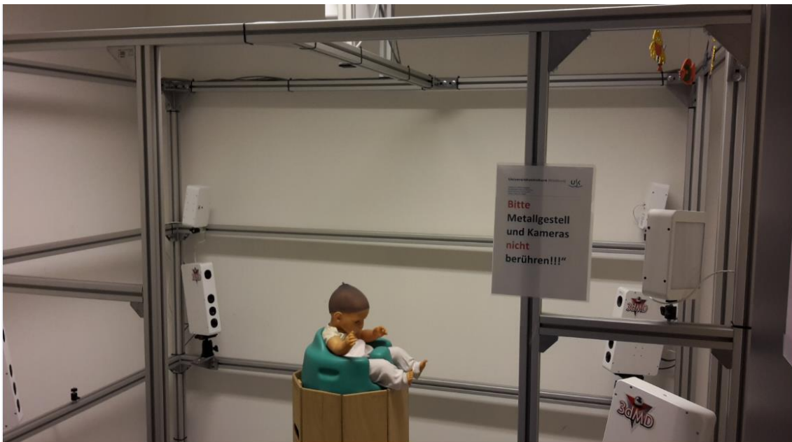
Abb. 3: Nachgestellter Versuchsaufbau mit Puppe im Scanner (3dMD®, Atlanta, GA, USA) in der Poliklinik für Kieferorthopädie Universitätsklinikum Würzburg.
