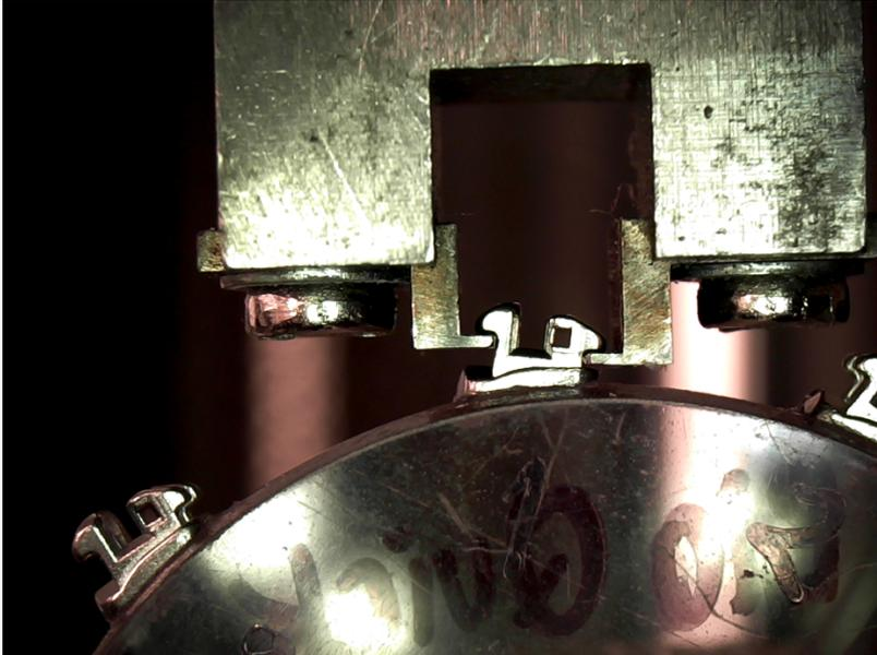
Abbildung 18: Fotografie des Abzugversuchs vom PMMA-Ring.
