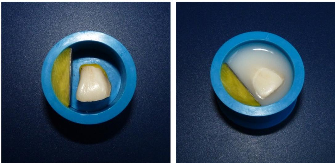
Abbildung 16: Fotografien eines im PTFE-Ring positionierten Zahnes mithilfe von zahntechnischen Setzwachs und einer Metallplatte. Links: Nach der Positionierung; Rechts: Nach dem Einbetten in Kunststoff.
