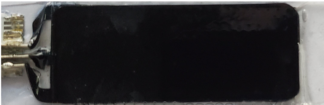
Abb. 5.9: Kombiniertes Näherungs- Druck- und Dehnungssensor mit Abmessungen 50 mm × 20 mm
