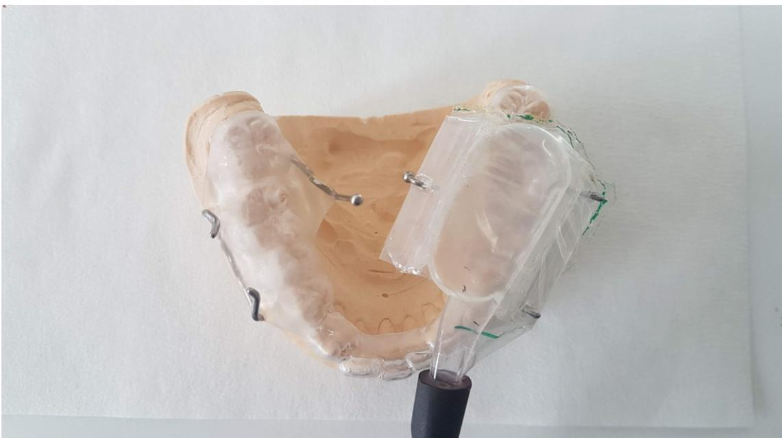
Abbildung 10: Unterkiefermodell mit okklusaler Trägerschiene, Haltedornen und fixiertem Drucksensor zur Messung der beim Kauen generierten Kaukraft.
