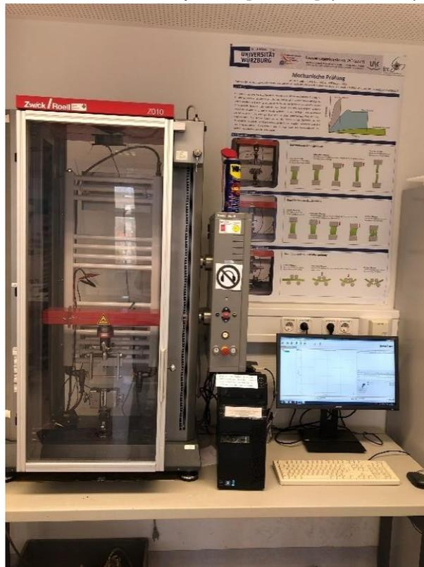
Abb. 13 Material-Prüfmaschine Zwick/Roell Z010 und PC mit Testsoftware TestXpert II V3.1.
