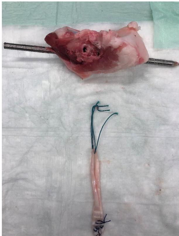
*Abb. 19 Beispiel 2: Versagen durch Ruptur des Fadenmaterials*
