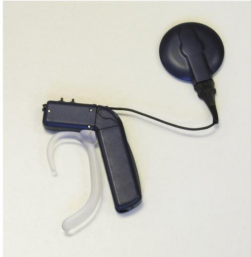
Abbildung 4.3: Externer auf dem Ohr zu tragender Implantatprozessor
